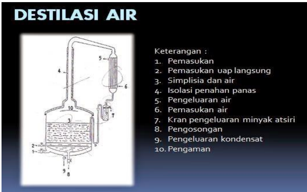
Gambar 5. Alat destilasi air
