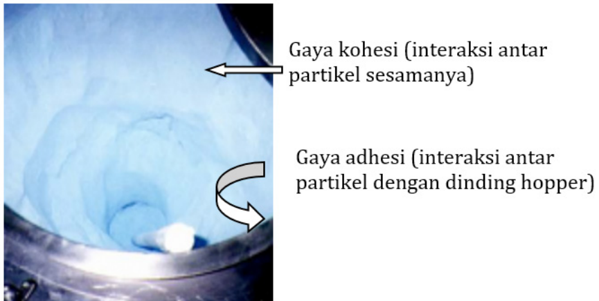
Gambar 2.3 Gaya adhesi dan kohesi yang terjadi pada hopper
