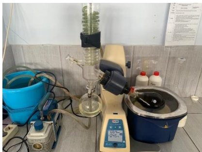
Pengentalan dengan menggunakan alat rotary evaporator
