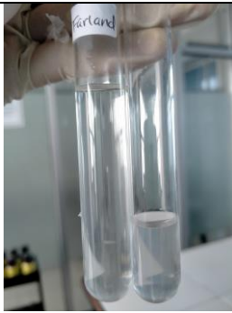
Suspensi bakteri yang dibandingkan kekeruhannya dengan larutan Mc Farland
