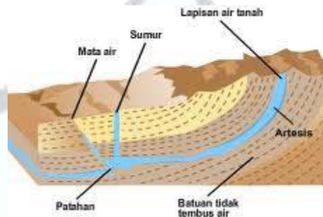
Gambar 2.1 Lapisan Air Tanah (Zahara, 2018)
