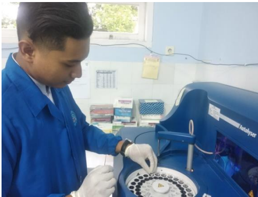
Gambar 5g. Masukan Sampel Kuvet dalam Alat Dialab Autolyser
