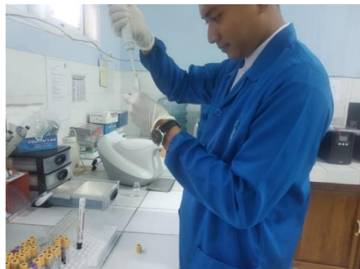
Gambar 5d. Pemisahan Serum Dari Tabung Menggunakan Mikropipet
